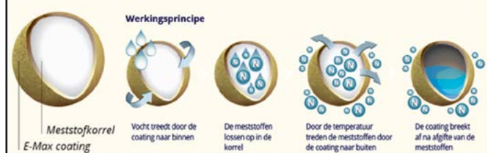
3. ábra: Az ICL Speciality Fertilizers E-Max membrántechnológiával ellátott szabályozott feltáródású műtrágya működési elve
